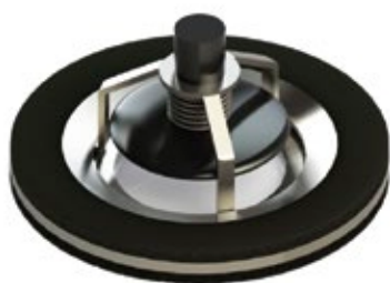
HYDROBLOCK-H2O SC con otturatore in PA66 e sistema automatico di sfianto aria, P N 10 bar - Temp. Max 130°C
