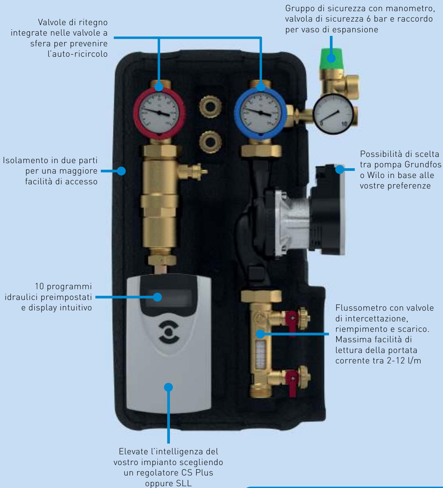
**LK 212 SolarStation** è un gruppo di pompaggio solare compatto a due tubi, disponibile con o senza regolatore. È un pacchetto completo con tutti i componenti essenziali per assicurare un funzionamento sicuro ed efficiente del vostro impianto di riscaldamento solare.
