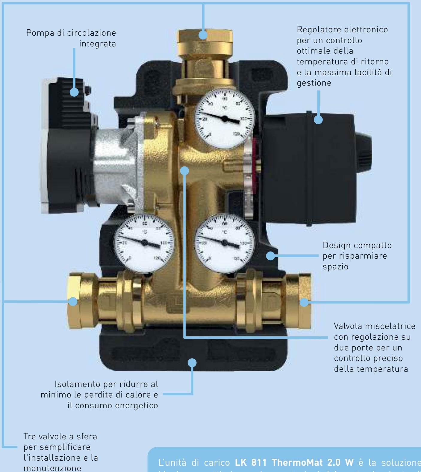
L'unità di carico **LK 811 ThermoMat 2.0 W** è la soluzione ideale per ottimizzare le prestazioni del vostro impianto di riscaldamento. Progettata per caldaie a combustibile solido e serbatoi di accumolo, questa unità compatta mantiene una temperatura di ritorno elevata prolungando la vita utile della caldaia. Può essere installata facilmente tra la caldaia a combustibile solido e il serbatoio di accumolo e adattandosi alle esigenze del vostro impianto.
