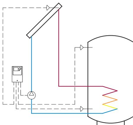
LK 150 SmartSol è un termoregolatore differenziale elettronico per impianti di riscaldamento solare. In base al modello, il termoregolatore è dotato di 20 o 24 impianti idraulici preimpostati per i vari impianti di riscaldamento solare. Lo stato di funzionamento e il sistema idraulico selezionati sono indicati nel display a colori retroilluminato. I comandi e le impostazioni sono facili da eseguire. LK 150 SmartSol è in grado di gestire pompe ad alto rendimento.
