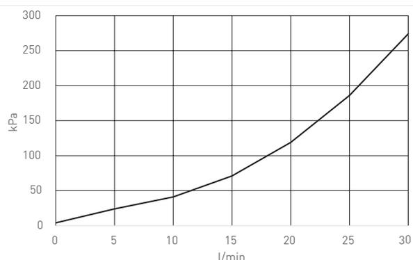
DIAGRAMMA DELLE PERDITE DI CARICO - LK 250 P
