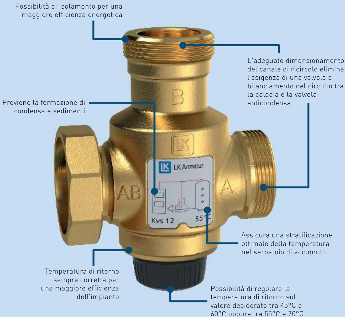
Ottimizzate il vostro impianto di riscaldamento con la valvola anticondensa termica a 3 vie LK 823 ThermoVar® R. Garantisce una distribuzione ottimale della temperatura nel serbatoio di accumulo, migliorando l'efficienza della caldaia e prevenendo la formazione di catrame e condensa. Grazie alla possibilità di regolare la temperatura di ritorno tra 45°C e 60°C oppure tra 55°C e 70°C, è la valvola ideale per il vostro impianto.
