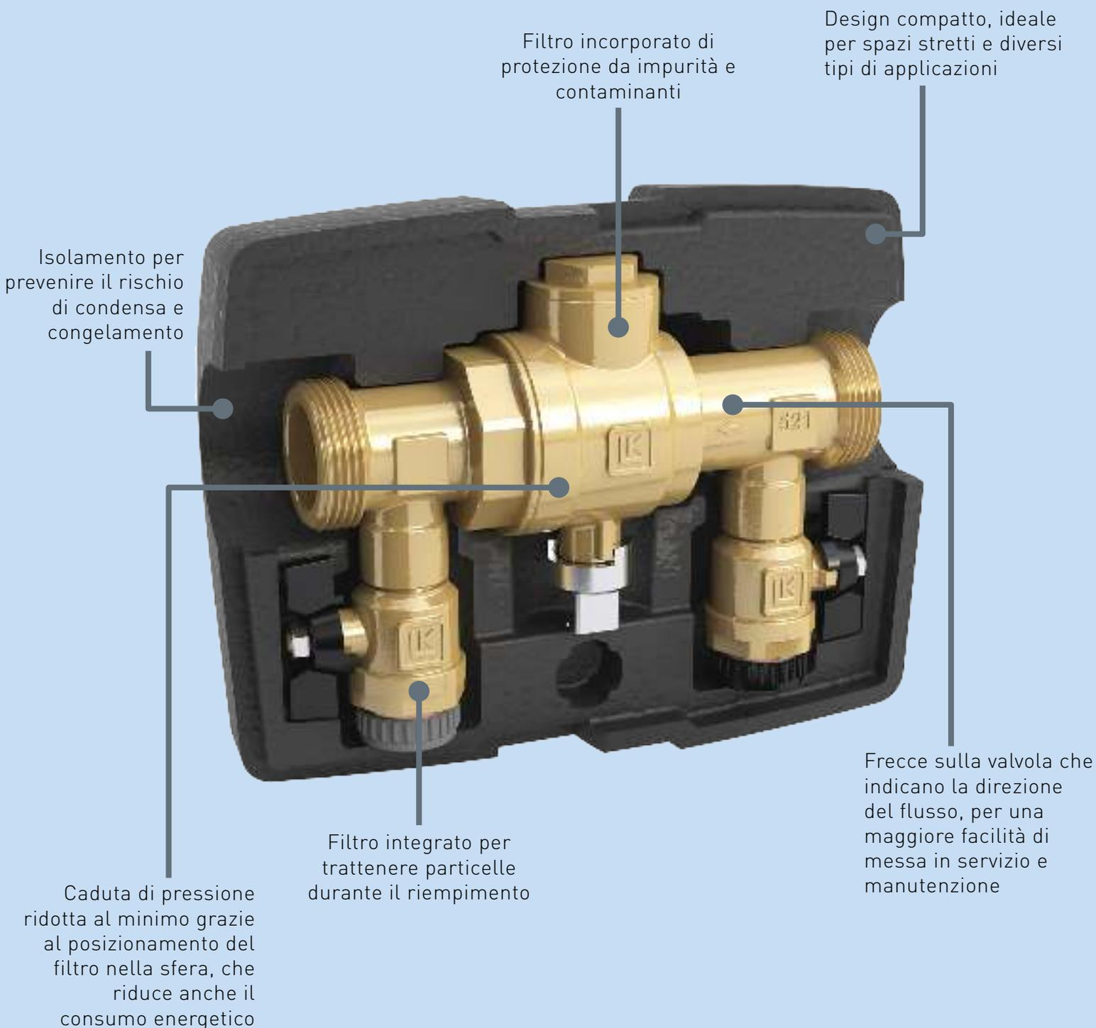
**LK 521 MultiFill®** semplifica il riempimento del fluido refrigerante negli impianti con pompa di calore geotermica. Il filtro incorporato protegge l'evaporatore dai potenziali contaminanti, mentre il design compatto semplifica l'installazione in spazi stretti. Isolamento di protezione da condensa e congelamento. Questa valvola versatile può essere utilizzata in diversi tipi di applicazioni che necessitano di riempimento e filtrazione.
