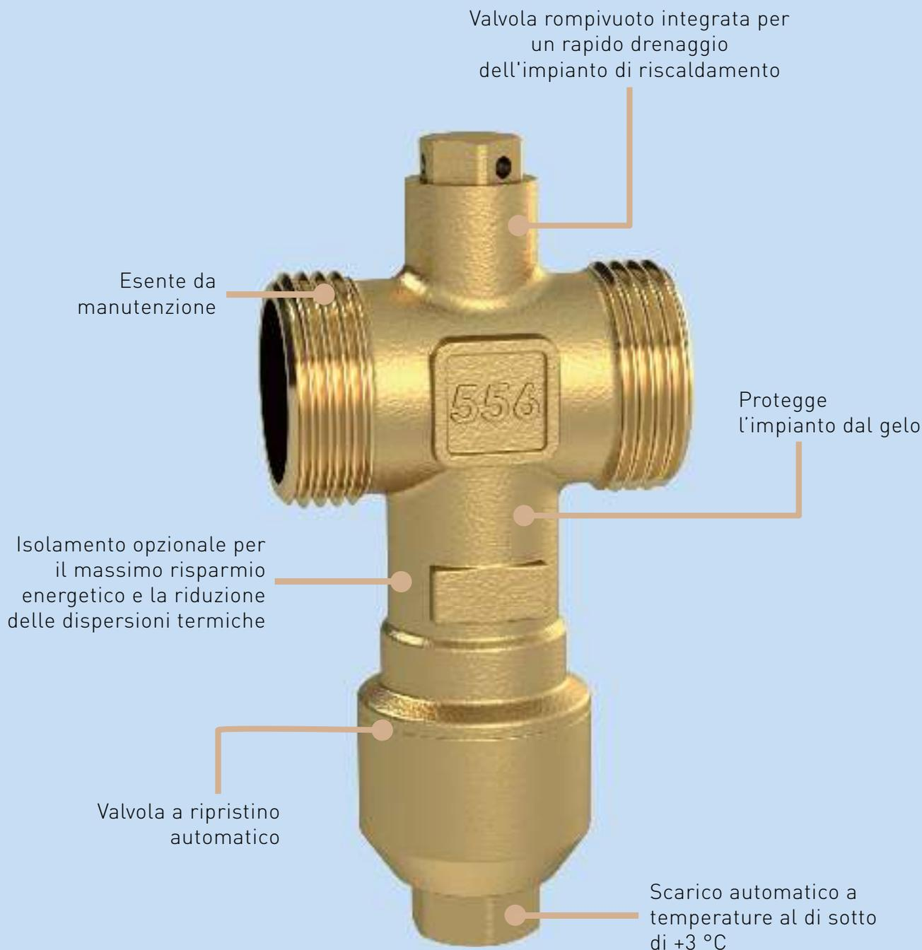
Protegete il vostro impianto di riscaldamento dal gelo con **LK 556 AntiFreeze**. Progettata per pompe di calore aria/acqua, scarica automaticamente l'impianto quando la temperatura scende al di sotto di +3°C, assicurando la massima sicurezza e il perfetto funzionamento del vostro impianto di riscaldamento. Migliora l'efficienza energetica con l'isolamento disponibile e approfitta dei vantaggi di una valvola esente da manutenzione.
