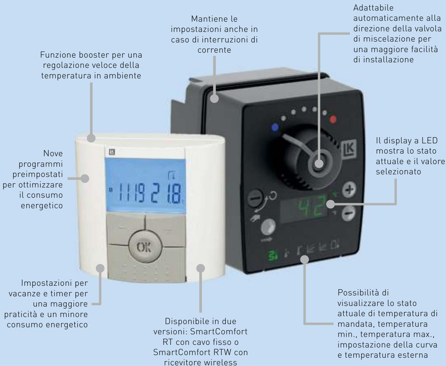
Ottimizzate il comfort ambientale con **LK 130 SmartComfort**. Questo regolatore intelligente offre un controllo preciso della temperatura e può essere integrato facilmente negli impianti esistenti. L'unità di regolazione della temperatura ambiente con programmi preimpostati e monitoraggio della temperatura esterna ottimizza ulteriormente il controllo. Inoltre, per la massima efficienza, è possibile connettere SmartComfort PC per gestire la pompa di ricircolo e prevenire il rischio di stallo.
