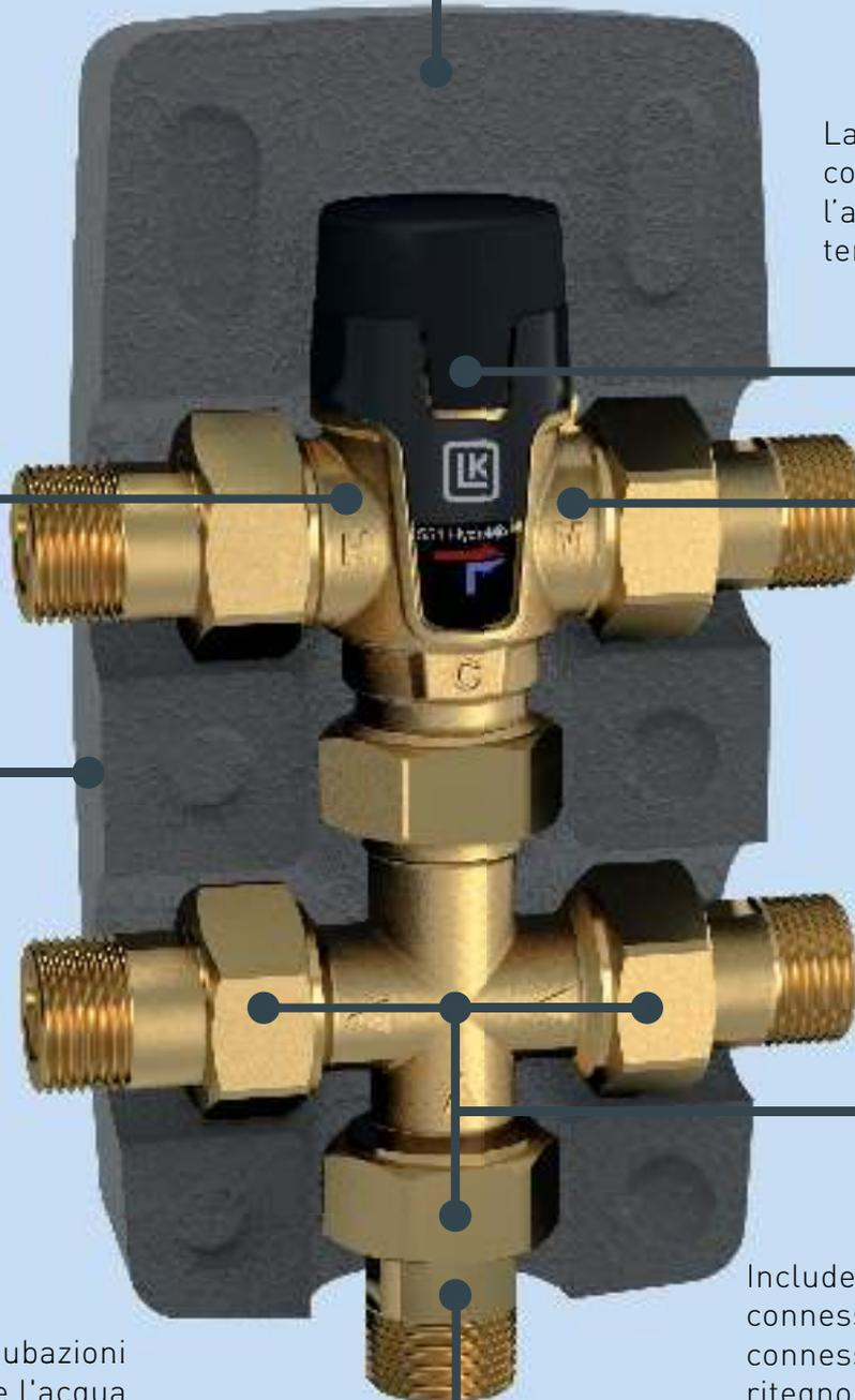
**LK 551 HydroKit HWC** garantisce acqua calda istantanea, anche negli edifici con tubazioni particolarmente lunghe. Questa unità compatta include una valvola miscelatrice, croce, kit di connessione e tre valvole di ritegno per un ricircolo ottimale dell'acqua calda. La valvola miscelatrice termostatica regola con precisione il flusso di acqua calda e fredda, offrendo un comfort ottimale e una sicurezza aggiuntiva grazie alla funzione anti-scottatura.
