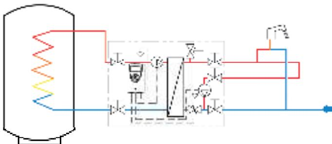
LK 250 TAPWATER UNIT - SENZA CENTRALINA CON RICIRCOLO ACQUA CALDA SANITARIA
