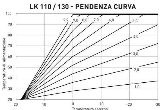
La curva di riscaldamento dipende dal dimensionamento del sistema di riscaldamento e dell'isolamento dell'edificio. La curva deve essere regolata per ottenere la temperatura ambiente desiderata. La pendenza della curva e lo spostamento parallelo sono facilmente regolabili con i pulsanti "+" e "-".
