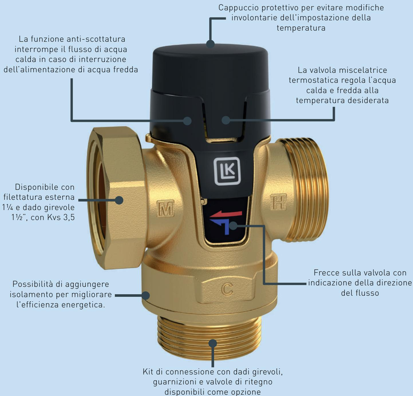
**LK 551 HydroMix** - una valvola miscelatrice asimmetrica che garantisce una temperatura dell'acqua calda stabile e sicura negli impianti di riscaldamento e acqua sanitaria. Il suo elemento termostatico regola il flusso di acqua calda e fredda, mentre la protezione anti-scottatura interrompe il flusso di acqua calda in caso di interruzione dell'alimentazione di acqua fredda. Installazione semplice grazie alle indicazioni di flusso sulla valvola.
