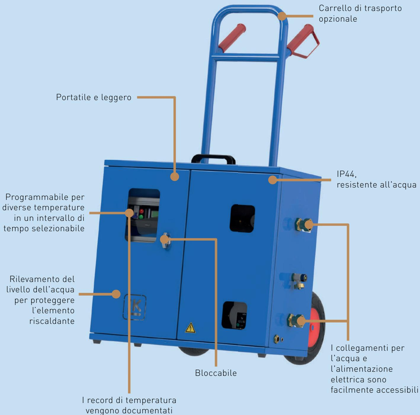
Progettata per esigenze di riscaldamento temporaneo, questa caldaia elettrica completa è la soluzione ideale per l'asciugatura di massetti in calcestruzzo e il riscaldamento nei cantieri. Dotato di una regolazione programmabile, un controllo costante della temperatura e un robusto armadio con serratura, la **LK EasyHeat 450 P** è la scelta affidabile per le vostre esigenze di riscaldamento.
