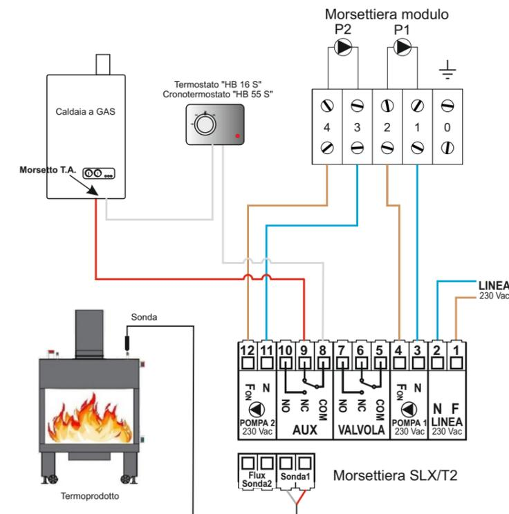
Quando viene installato il modulo mini e cioè quello con un solo circolatore, è necessario utilizzare la pompa nr. 2 della centralina: l'uscita ausiliaria «AUX» è legata all'attivazione della pompa nr. 2.
