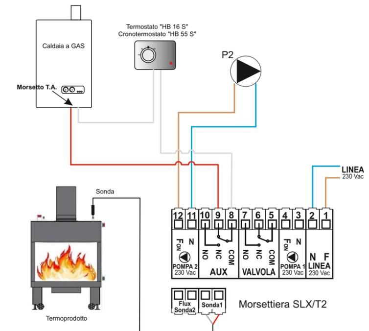
Quando viene installato il modulo mini e cioè quello con un solo circolatore, è necessario utilizzare la pompa nr. 2 della centralina: l'uscita ausiliaria «AUX» è legata all'attivazione della pompa nr. 2.
